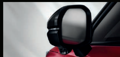
Honda LaneWatch ระบบแสดงภาพมุมมองด้านหลังเปลี่ยนเลน
