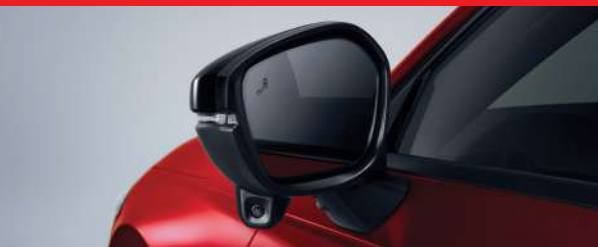
Blind Spot Information (BSI) ระบบช่วยเตือนมุมอับสายตาที่กระจกมองข้าง Honda LaneWatch ระบบแสดงภาพมุมอับสายตาขณะเปลี่ยนเลน
