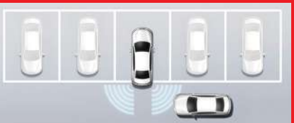
Cross Traffic Monitor (CTM) ระบบเตือนเมื่อมีรถเคลื่อนผ่านขณะถอย
