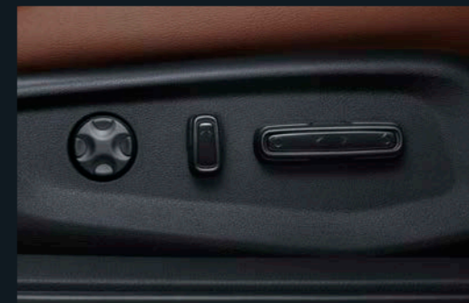
เบาะนั่งด้านคนขับปรับไฟฟ้า 8 ทิศทาง พร้อมปุ่มปรับด้านหลัง 4 ทิศทาง
