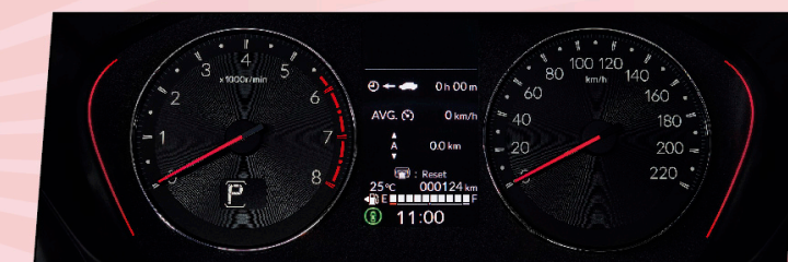
มาตรวัดพร้อมหน้าจอแสดงผลข้อมูลการขับขี่แบบ TFT ขนาด 4.2 นิ้ว
