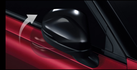
Electric Adjustable and Auto Foldable Side Door Mirrors กระจกมองข้างปรับไฟฟ้าพร้อมพับเก็บอัตโนมัติ
