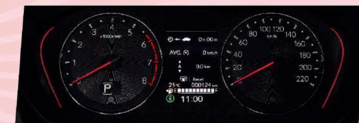
มาตรวัดพร้อมหน้าจอแสดงผลข้อมูลการขับขี่แบบ TFT ขนาด 4.2 นิ้ว
